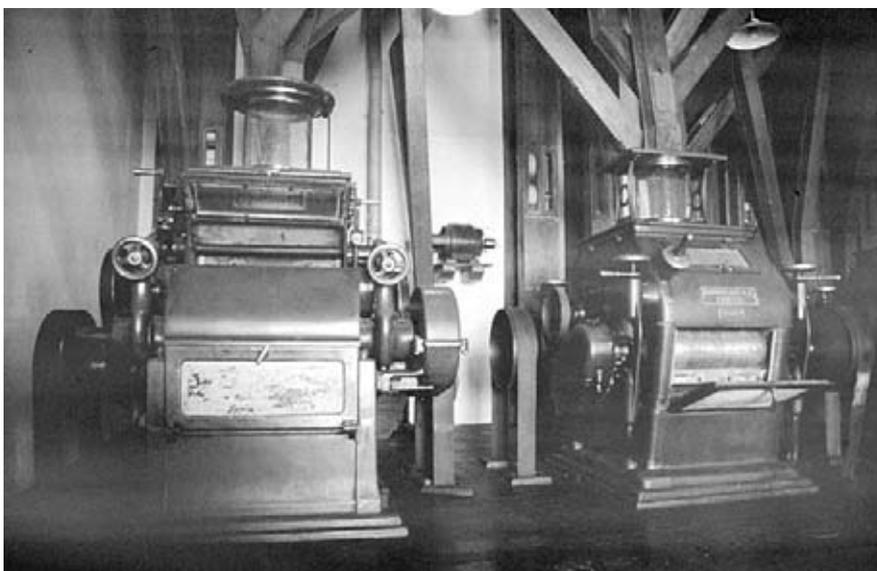
Dos clases de molino de cilindros: Morros (izq) y Daverio; las ruedas arreglan la distancia entre los cilindros.
