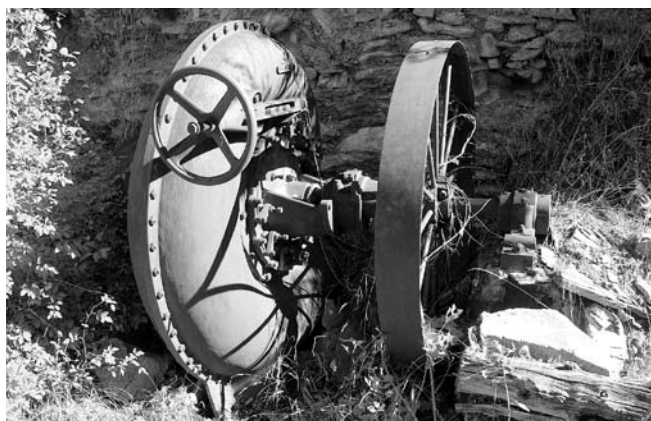
Turbina con regulador y rueda con cinta
