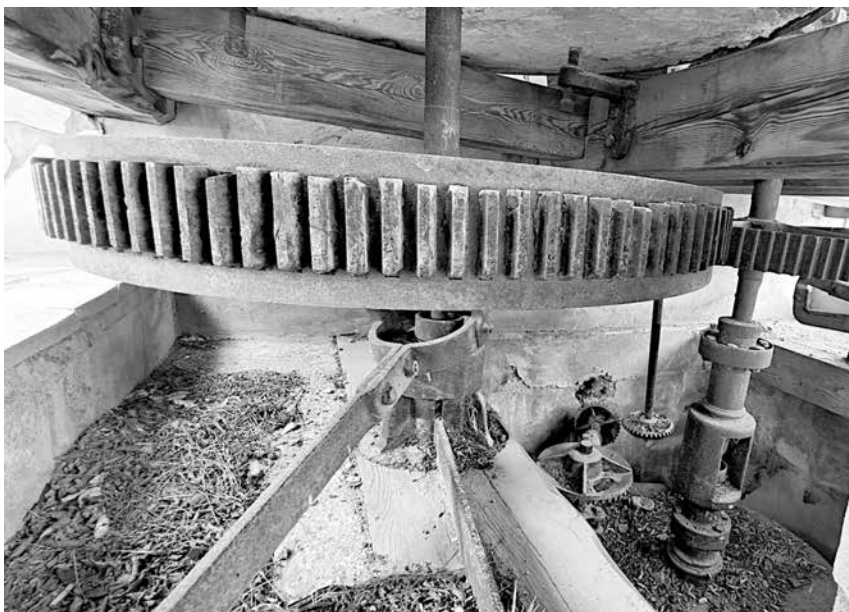
Engranaje con dientes de madera; abajo a la derecha la turbina Fontaine - 9
